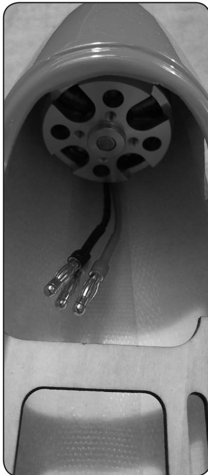
**19** Die Luftschraubenblätter am Spinner befestigen. Den fertig montierten Spinner soweit auf die Motorwelle schieben, dass dieser nicht am Rump schleift und nur einen minimalen Spalt zwischen Rumpf und Spinnerkappe aufweist.
