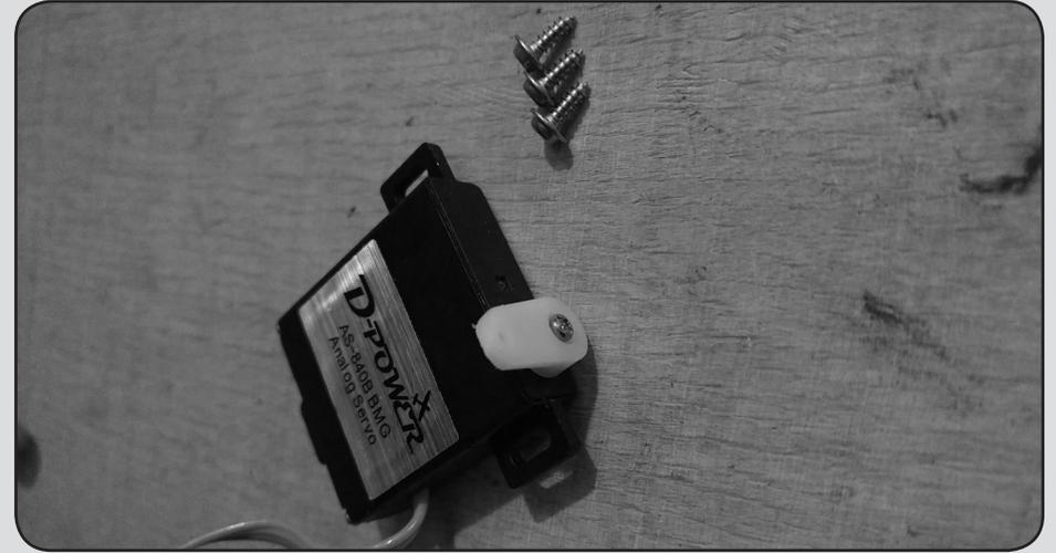
**08** Das Servo mit Schrauben am Servorahmen im Servoschacht befestigen. Das Servoanschlusskabel mit dem bereits in der Tragfläche eingezogenen Verlängerungskabel verbinden und das Kabel im Schacht verstauen. **HINWEIS:** Schraubenlänge prüfen und ggf. kürzen, sodass die Schrauben nicht an der Tragflächenoberseite austreten.
