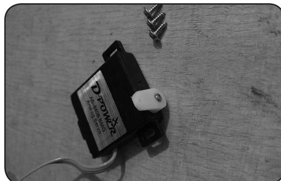
**03** Das Servo mit Schrauben am Servorahmen im Servoschacht befestigen. Das Servoanschlusskabel mit dem bereits in der Tragfläche eingezogenen Verlängerungskabel verbinden und das Kabel im Schacht verstauen. **HINWEIS: Schraubenlänge prüfen und ggf. kürzen, sodass die Schrauben nicht an der Tragflächenoberseite austreten.**
