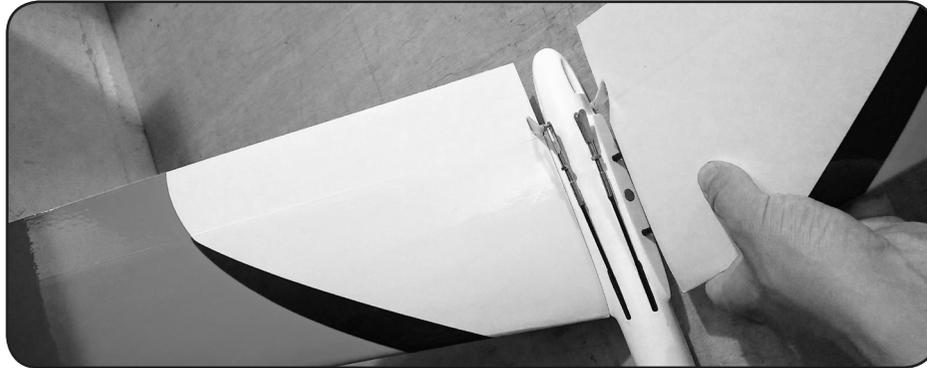
**14** Die beiden Anlenkgestänge, welche am Rumpfende austreten, mit den Ruderhörnern der Ruderklappen verbinden.
