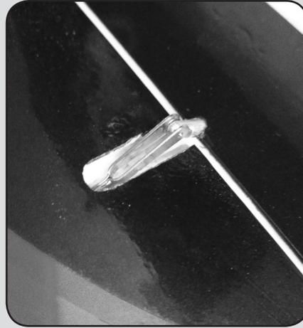
**10** Die Servoschachtabdeckung mit Tesa befestigen.
