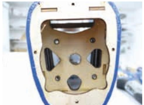
Monter le moteur à l'aide de 4 vis M4 dans la coque, l'hélice était auparavant pas raccourci pour qu'il donc pas trop loin des projets modèles
