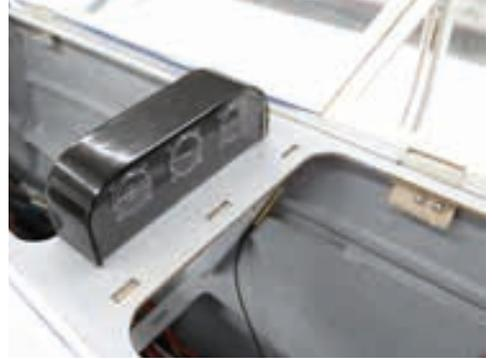
Le tableau de bord avant est simplement vissé avec deux vis pour obtenir plus facilement par la suite à moteur et le contrôleur. Les deux sièges sont simplement tenus par les aimants, un accès facile ainsi déjà collé à la batterie et le récepteur est possible
