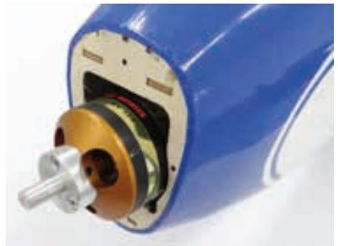
Montez ensuite le nez en fibre de verre, c'est simplement vissé avec une vis M3 du poste de pilotage fixe
