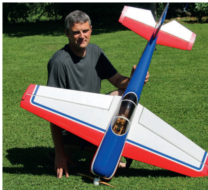
Ce modèle affiche 1,40 m d'envergure et les ailes sont en deux parties. Le stabilisateur n'est pas démontable. Notez la surface énorme des ailerons...
