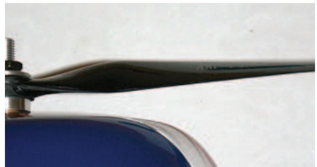
Picture 24: Distanz Motorhaube - Luftschraube
