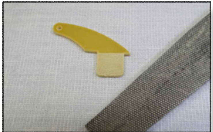
Rauen sie die GFK Landeklappenscharniere gut an
