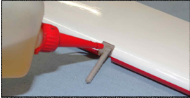
Ölen Sie die 3 Drehpunkte ein, damit nichts verklebt
