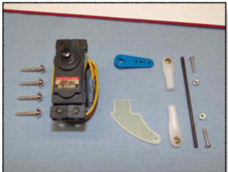
Bereiten Sie alles für den Servoeinbau und Anlenkung vor
