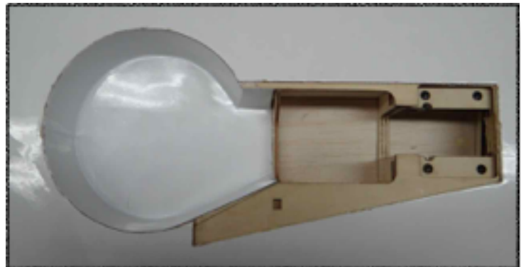
Den oberen Rand am besten mit dünnen Sekundenkleber mit einer Nadel verkleben, aufpassen, dass kein Kleber auf die Folie kommt
