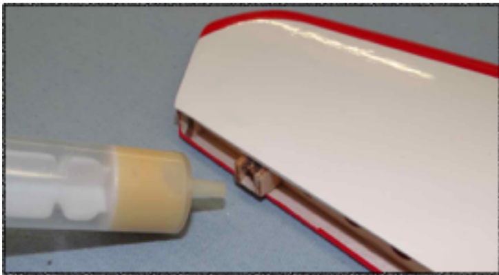
Und verkleben Sie den Dämpfer mit der Höhenruders-flosse.
