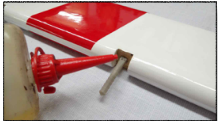
Um ein Verkleben zu verhindern ölen sie den Drehpunkt ein
