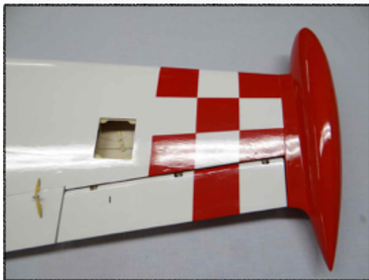
Richten sie das Querruder entlang der Endleiste aus
