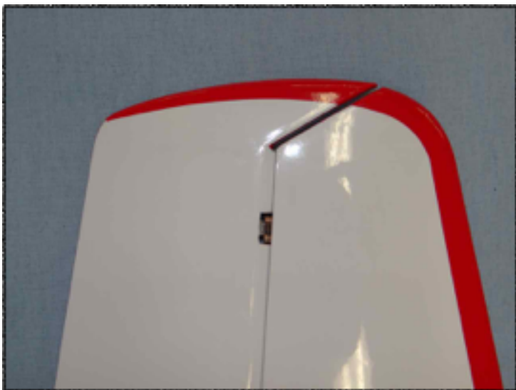
Achten Sie darauf das der Spalt zwischen Ruder und Dämpfer gleichmäßig ist.
