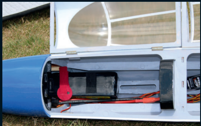
L'accu LiPo 5 à 6S est positionné le plus possible à l'avant. Il est très facile à mettre en place grâce à la bulle articulée d'origine.
