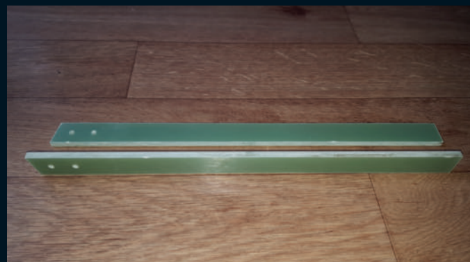
Voici les clés d'ailes : de longues lames de fibre de verre de 6 mm d'épaisseur qui seront collées dans les ailes.
