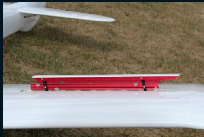
Proposés en option, les aérofreins électriques ne sont pas indispensables. À noter que, sur le réel, les aérofreins sont présents à l'extrados et à l'intrados.
