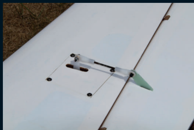
Les ailerons se contentent de servos avec un couple de 4,5 kg.cm environ.
