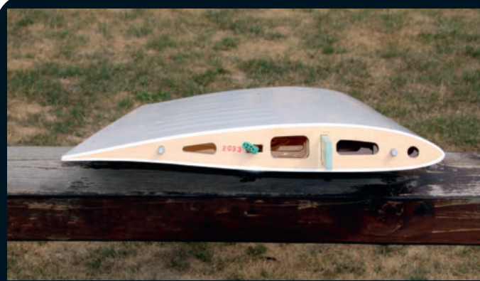
Le profil des ailes ressemble fortement à un Wortmann FX 60-126, parfaitement adapté sur un modèle à la charge alaire assez faible.
