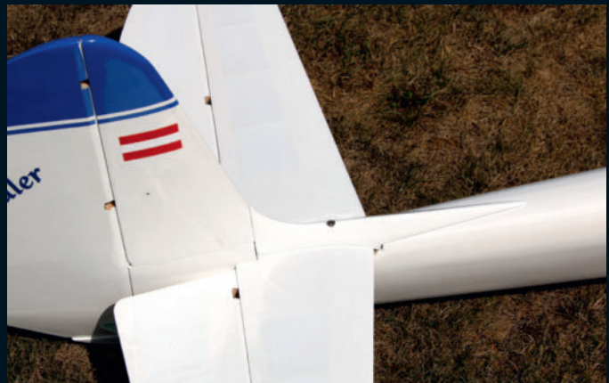
Le stabilisateur est fixé avec une unique vis M4 et se démonte facilement.
