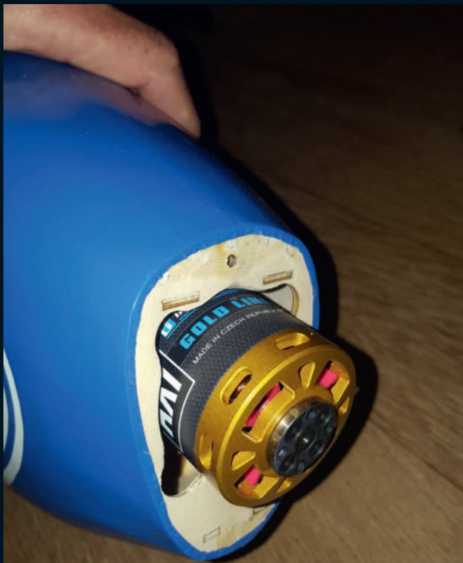
Ce Musger est prévu d'origine pour être motorisé. Le moteur préconisé, un Axi 4130/16 V2, passe tout juste.
