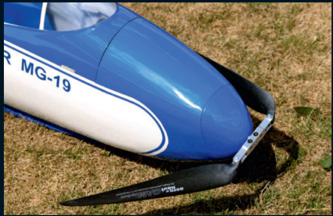
Le capot avant est en fibre de verre et une fois replié, l'hélice reste assez discrète.
