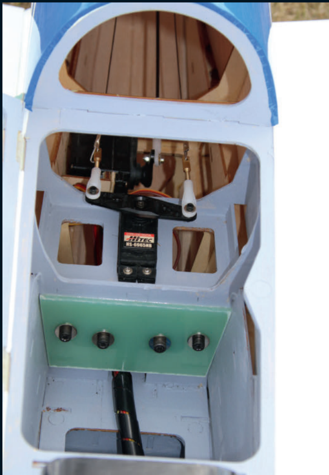
Les quatre vis BTR servent à fixer les clés d'ailes. Au-dessus, on voit le servo de dérive et, juste derrière, celui de la profondeur.
