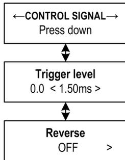
*Trigger level* – Einstellung des Triggerniveaus des Eingangs-Steuersignals. (z. B.: Das „Trigger level“ ist auf 1.50 ms eingestellt und „Reverse“ auf OFF“. MSPEED wertet aus, dass es zu einer Überschreitung kam, wenn das Steuersignal größer, als 1.50 ms war und das Akustiksignal des Indikators von MSPEED wird eingeschaltet. Nur nach der ersten Überschreitung des Triggerniveaus „Trigger level“ durch das Steuersignal wird die Aufzeichnung automatisch gelöscht und
