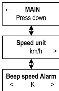
*Speed unit* – Einstellung der Einheiten des MSPEED-Sensors
