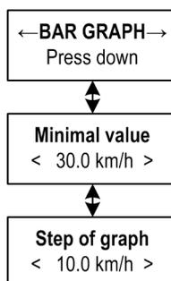
*Minimal value* – Minimalwert des Balkendiagramms. Nach Überschreitung dieses Wertes wird im Balkendiagramm die erste Position ausgefüllt, und falls kein Steuersignal angeschlossen ist, wird das Extrem gelöscht.
