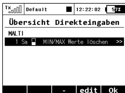
Im Menü „Clear MIN/MAX values“ können Sie einen Schalter/Taster/Schieber für das Löschen der min./max. Werte zuordnen.
