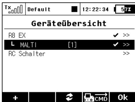
Der MAlti Sensor kann bequem über die Sender der Duplex DC/DS Reihe konfiguriert werden. Dazu wird das MAlti an den "EXT." Steckplatz eines gebundenen Empfängers gesteckt. Dieser Empfänger wird auf "EX Bus" eingestellt. Dann erscheint das Menü des MAlti unter *Modellwahl/-modifikation* → *Geräteübersicht*.
