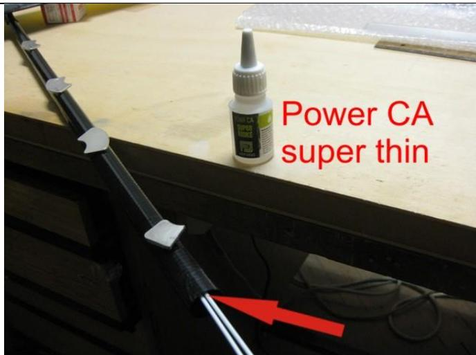
Anschliessend die Bowdenzüge innen im Rumpf mit dünnflüssigem Sekundenkleber einkleben (der Kleber über die Bowdenzüge ins Rumpfinnere ziehen lassen).
