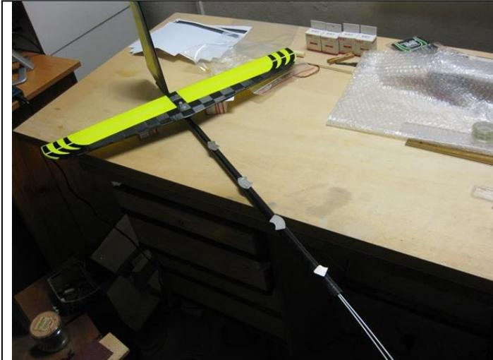
Die Stahldrähte in die beiden Bowdenzüge einführen und mit Magneten von aussen im Rumpf justieren.
