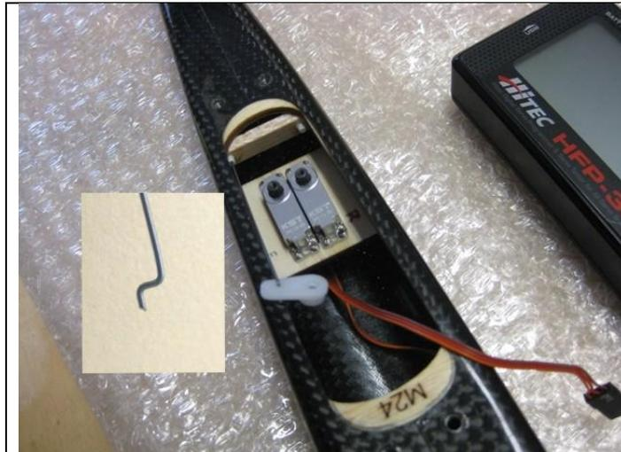
Einbau der beiden KST X08 Servos.
