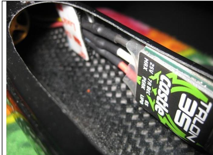
Prüfen, dass die Kabel den Motor nicht berühren.
