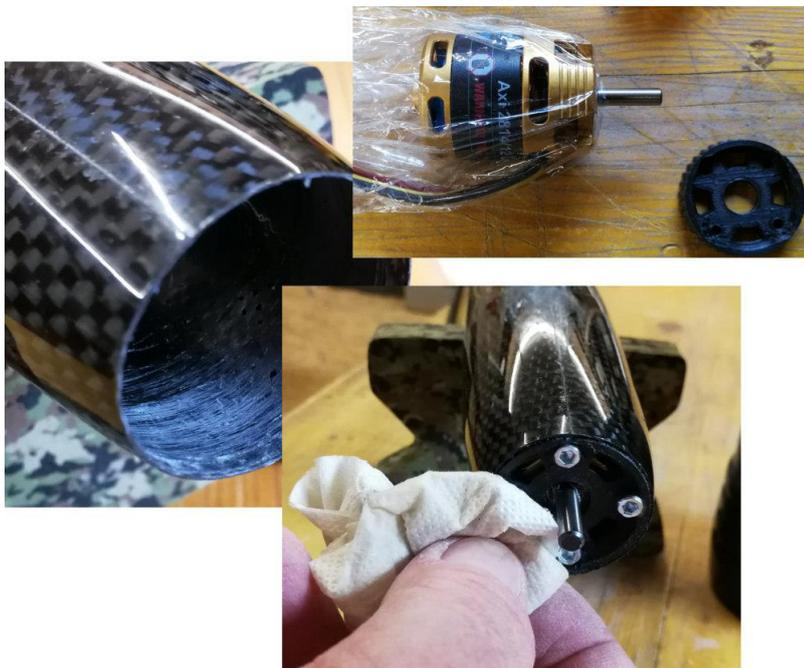
Bauen Sie den Motorspant ein. Der Motor wird mit Frischhaltefolie eingepackt, den Spant auf den Motor geschraubt und im Rumpf einsetzen.
