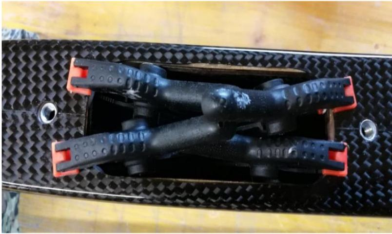
Flächenbefestigungs-Spant 2 mit dem Rumpf verkleben und gut mit Klammern fixieren.
