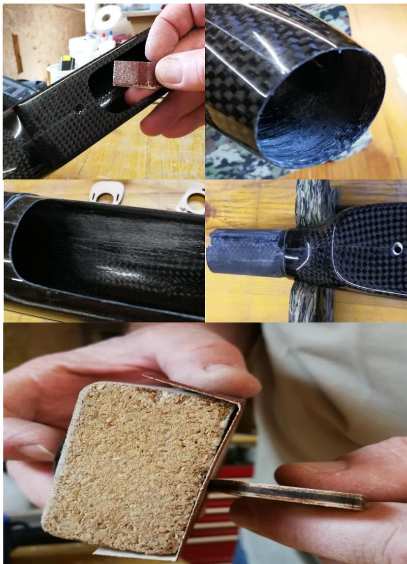
Mit Schleifpapier der Körnung 80 rauhen wir alle Bereiche an, die mit den Spanten oder einem anderen Teil verklebt werden.
