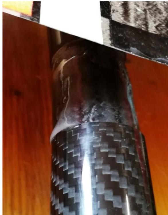
Den Mittelflügel auf das Rumpfboot schrauben und die beiden Teile, Rumpfröhre und Rumpfboot mit 5 Minuten Epoxy verleimen.
