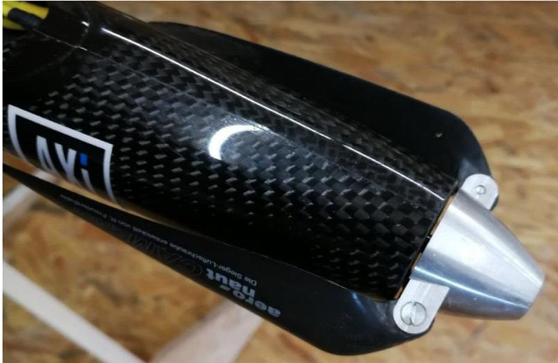
Motor und Regler einbauen, Propeller und Spinner montieren und der Rumpf ist soweit fertiggestellt.
