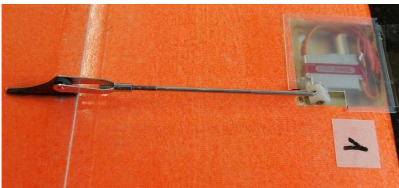
Servoschacht Abdeckung für Querruder und Wölbklappen aus dünnem PVC zuschneiden und mit transparentem Klebband auf die Fläche kleben. Fertig!
