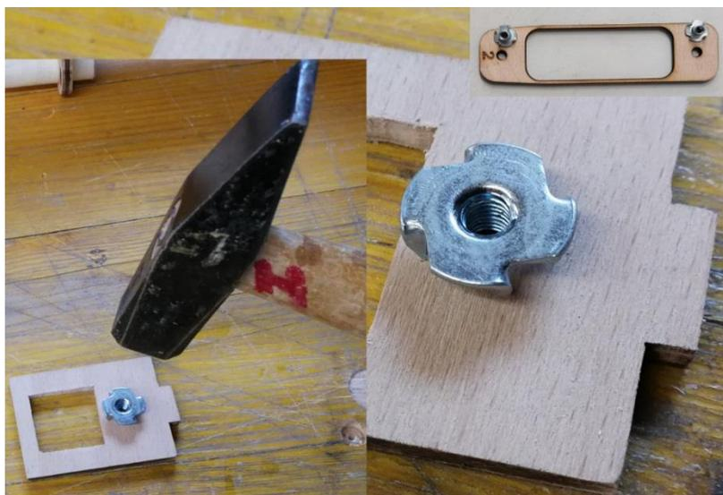
Am Servobrett und an der Tragflächenbefestigung die Einschlagmutter vorsichtig mit einem Hammer einschlagen. Um ein späteres Herausdrücken zu verhindern empfehlen wir Ihnen etwas 5 Min Epoxy auf das Servobrett zu streichen.
