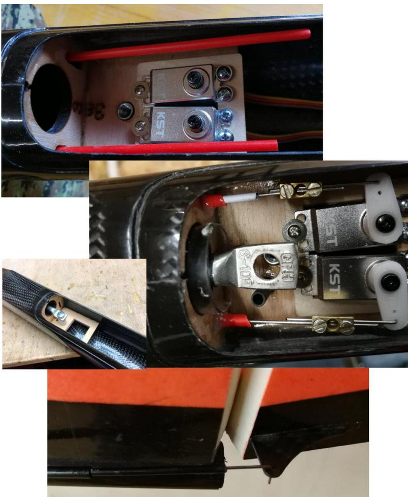
Bowdenzüge ablängen, Seele mit 0.8 mm Stahldraht einsetzen, abwinkeln in den Ruderhörner einhängen und an die Servos anschliessen.
