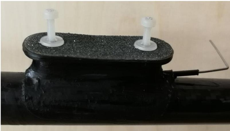
Höhenruder auf den Sockel schrauben und rechtwinklig (90°) zum Seitenruder ausrichten, mit 5 Minuten Epoxy verkleben.
