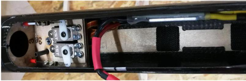
Für die Befestigung des Lipo Akkus habe ich ein Brett im Rumpfboden eingeklebt und kann so den Akku sauber befestigen.
