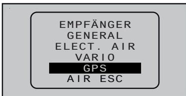
Dieses Display visualisiert die Daten eines ggf. an den Empfänger angeschlossenen GPS-Moduls mit integriertem Vario (Best.-Nr. 33600).
