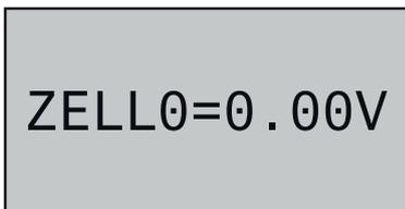
Nach Verfügbarkeit des entsprechenden Sensors zeigt dieses Display die aktuell niedrigste Zellenspannung eines Akku-Blockes sowie die Nummer der betreffenden Zelle.
