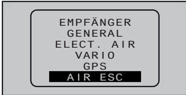
Dieses Display visualisiert die Daten eines ggf. an den Empfänger angeschlossenen Brushless-Reglers mit HoTT-kompatibler interner Telemetrie.
