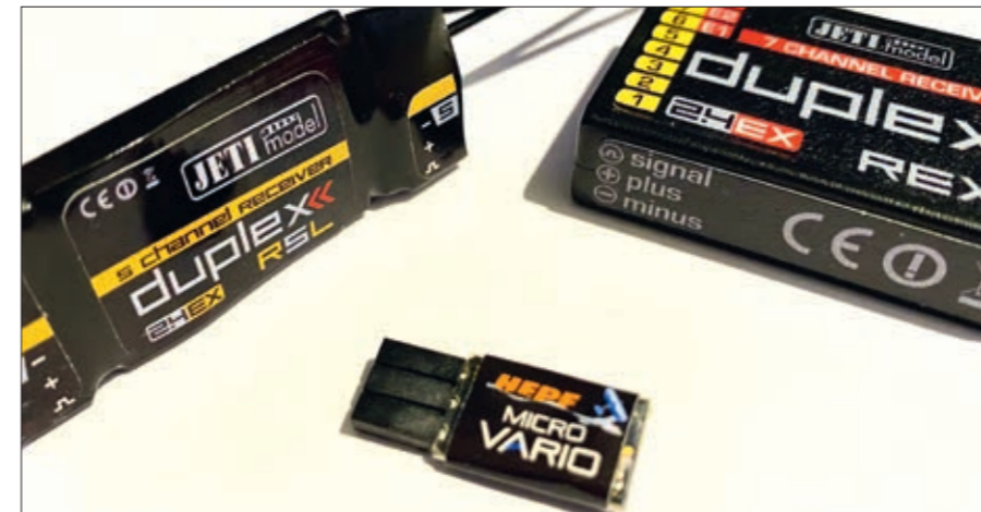
Getestet wurde das Micro Vario von Hepf mit den Jeti-Empfängern REX7 und R5L
