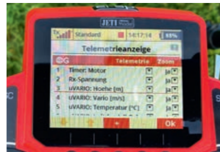
Über den Sender lässt sich frei entscheiden, welche Werte angezeigt werden sollen
