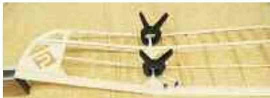
**Das Verkleben der Winglets bzw. der äußeren Ohren gelingt sehr einfach nach dem passenden Schliff der Anschlussrippen mit Hilfe der beiliegenden Schablonen. Hier gibt es genügend stabile Bauteile, um mit Klammern die richtige Position zu halten.**
