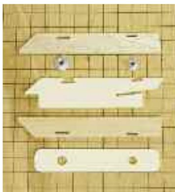
Der Dom für das Höhenleitwerk ist regelkonform komplett aus Holz. Lediglich die Muttern für das abnehmbare Höhenleitwerk sind aus Alu.
