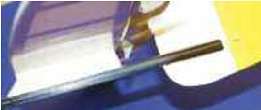
Auf Leichtgängigkeit bei den Anlenkungen muss sorgsam geachtet werden. Das Seitenleitwerk wird mit 5 Minuten-Epoxi mit dem CfK-Rohr verklebt.
