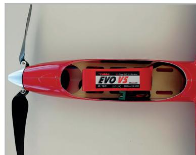
Anschließend kann der Rumpfbodendeckel mit UHU Por befestigt werden. Achten Sie zuvor, dass sämtliche Servosteckverbindungen und das Empfänger seitige Reglerkabel nach vorne in Richtung Akkuraum weisen um später am Empfänger angeschlossen werden zu können.
