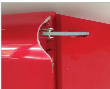
Anschließend muss das Gestänge zuerst auf der Servoseite durch den Gestängeanschluss geführt werden um dann am Seitenruder eingehängt werden zu können.
