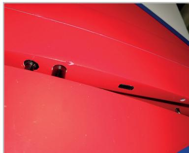
Montieren Sie das Modell vollständig mit Flächen und Leitwerke zusammen. Die Querruderservos werden an Rumpf-Servoanschlussbuchse angeschlossen. Das überschüssige Kabel beim Aufschieben der Tragfläche kann einfach in den Flügelhohlräum verstaut werden.
