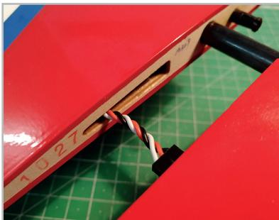
Abschließend verbinden Sie Ihren Empfänger entsprechend dem Anschlussplan des Senderherstellers mit den Servos und Regler. Der Empfänger kann am hinteren Ende, unterhalb der Haubenrahmens mit z.B. Klettband befestigt werden.
