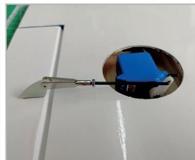
Analog zu den beiden Leitwerksservos, prüfen Sie auch für die beiden bereits eingebauten Querruder Servos, ob der erforderliche Ruderausschlag möglich ist. Wichtig dabei, dass die Neutralstellung des Servohebels NICHT 90° zum Gestänge aufweist, sondern um mind. einen Zahn am Servohebel in Richtung Nasenleiste zeigt. Dies ermöglicht in der Folge eine mechanische Differenzierung welche besonders für die nach stark nach oben gestellten Querruder in Ladekonfiguration hilfreich ist.
