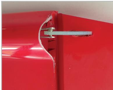
La tringlerie doit être guidée à travers l'espace menant au guignol sur le fuselage
