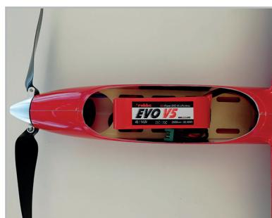
La batterie 4S 2600mAh recommandée trouve sa place sur le support de batterie et peut être déplacée sur une large plage pour le réglage du centre de gravité. Le montage peut être effectué selon les préférences individuelles. Nous recommandons l'utilisation d'une bande velcro et, en plus de la fixation, d'insérer des attaches de câble velcro à travers les fentes du support de la batterie. Cela permet de maintenir la batterie en place en toute sécurité.
