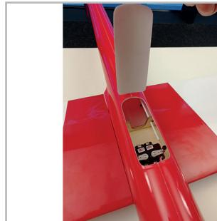
Le couvercle du plancher du fuselage peut ensuite être fixé avec de la colle UHU Por. Veillez à ce que tous les connecteurs des servos et les câbles du côté du récepteur soient orientés vers l'avant, vers le compartiment de l'accu, afin qu'ils puissent être connectés ultérieurement au récepteur.
