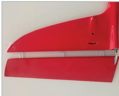
La gouverne de direction est déjà préfabriquée avec des fentes et des charnières et doit être collée à l'extrémité du fuselage. Vérifier que la déflexion est possible. Collez ensuite les charnières sur le fuselage et la gouverne de direction à l'aide d'une fine colle cyanoacrylate. Il suffit que de la superglue soit déposée dans l'espace de la charnière. Vérifier que la défexion est possible.
