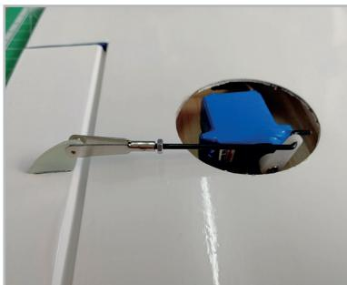
Comme pour les deux servos de dérive et de profondeur, vérifiez également les deux servos d'aile déjà installés. Il est important que la position neutre des palonniers ne soit PAS à 90° de la tringlerie, mais qu'elle pointe légèrement vers le palonnier dans la direction du bord avant.
