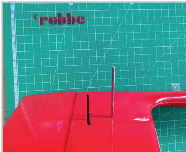
La profondeur est fixée au fuselage à l'aide de deux tiges d'acier. Il suffit de taper les deux tiges d'acier au extrémités à plat légèrement avec un marteau jusqu'à ce que cela soient fixes.
