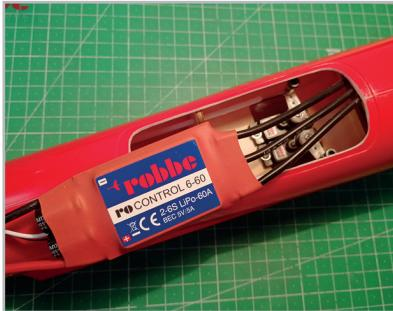
Le contrôleur est poussé sous le panneau de batterie via l'accès inférieur du fuselage et est connecté au moteur.
