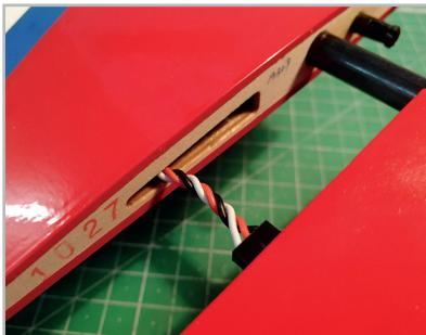
Enfin, connectez votre récepteur aux servos et au contrôleur selon le schéma de connexion du fabricant de l'émetteur. Le récepteur peut être fixé à l'arrière, sous la verrière, à l'aide d'une bande velcro, par exemple.
