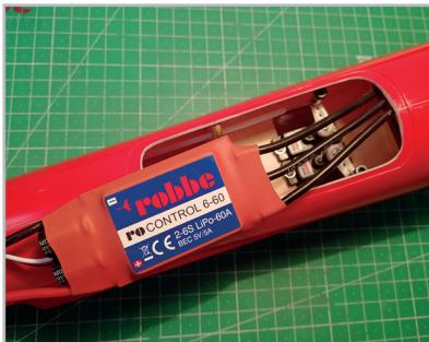
Der Regler wird über den Rumpfbodenzugang unter das Akkubrett geschoben und am Motor angeschlossen.
