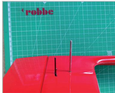
Die beiden Hälften werden mittels zweier Stahldrähte am Rumpf gesteckt. Zur Sicherung reicht es völlig aus, die beiden Enden des dickeren Stahldrahtes mit einem Hammer etwas flach zu klopfen. Nur so viel, dass die Leitwerkshälften nicht mehr locker sitzen, aber auch nicht zu schwer aufzustecken sind.
