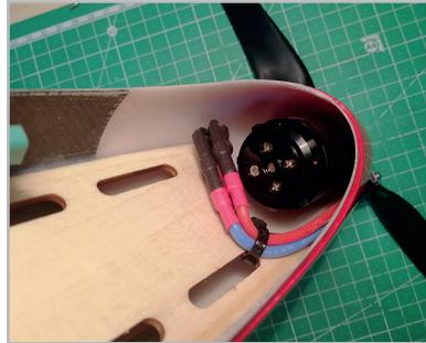
Testez ensuite le sens de rotation du moteur à l'aide de votre émetteur SANS l'hélice montée. Si le sens n'est pas le bon, inversez deux des trois câbles de connexion du moteur. Si le sens est bon, fixez les câbles comme sur la photo ci-jointe à l'aide de serre-câbles, par exemple. Le porte pales peut ensuite être monté avec l'hélice. Il devrait y avoir un petit espace entre le fuselage et le cône pour éviter que le cône ne frotte contre le fuselage.
