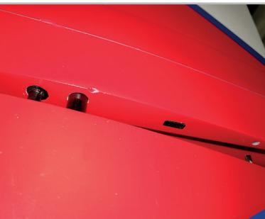
Assemblez le modèle complètement. Les servos d'aileron sont reliés à la prise servo du fuselage. L'excédent de câble peut être facilement rangé dans la cavité de l'aile.
