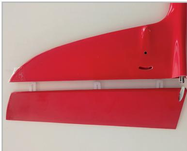
Das Seitenruder ist bereits mit Schlitten und Scharnieren vorgefertigt und muss noch am Rumpfende Festgeklebt werden. Stecken Sie das Ruder an den Rumpf, prüfen ob der erforderliche Ruderausschlag möglich ist. Und kleben sie dann mittels dünnflüssigen Sekundenkleber die Scharniere mit dem Rumpf und dem Seitenruder fest. Es reicht wenn im Spalt des Scharnieres Sekundenkleber eingeträufelt wird.
