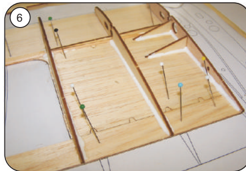
6 Rippe F 9 einleimen und gerade ausrichten, Klebestellen nachträglich vermuffen
