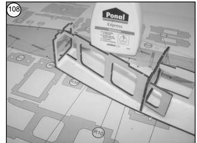
Bild 108 - Kopfspant R 1 unter Leimzugabe ansetzen.
