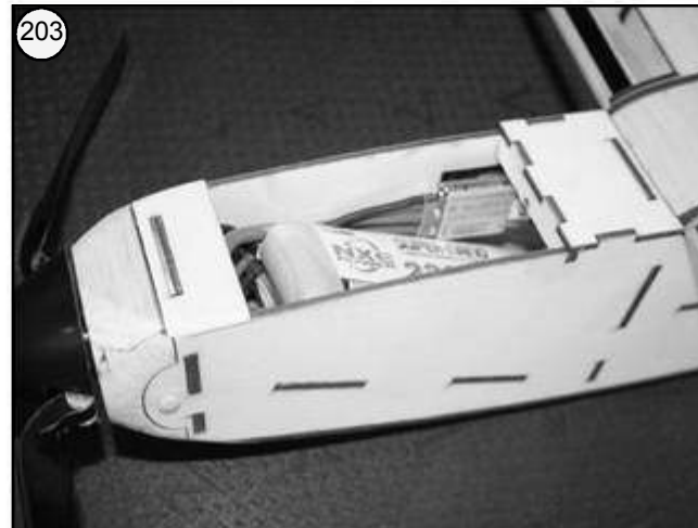
Bild 203 - Motorregler mit Klettband an der Seitenwand anbringen. Die Lage des Antriebsakkus ergibt sich beim Auswiegen. Ermittelte Akkuposition markieren und Akku ebenfalls mit Klettband sichern.
