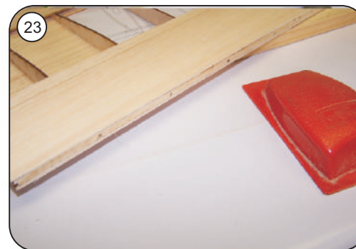
Beplankungsüberstände an der Vorderkante bündig mit F 20 verschleifen
