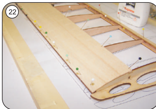
Beplankung bis zum Durchtrocknen mit Stecknadeln fixieren
