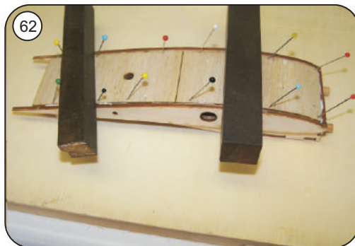
62 Obere Beplankung M 11 / M 12 aufkleben, nochmals Gewichte auflegen
