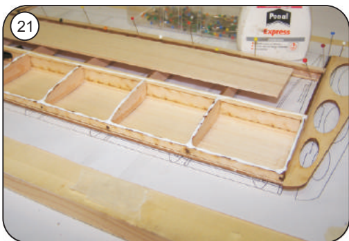
Obere Nasenbeplankung F 24 aufleimen, auf satte Verklebung achten
