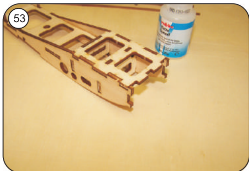
Boden unten M 5 einsetzen und anheften
