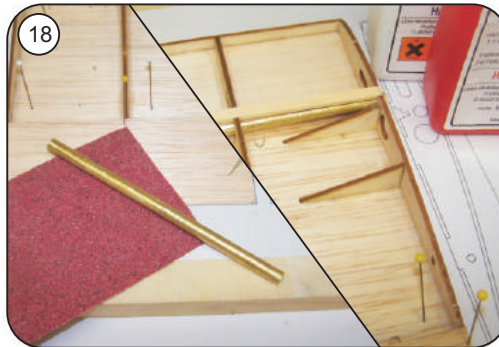
Steckungsrohr F 23 mit Schleifpapier anrauen und mit Epoxyleber einkleben
