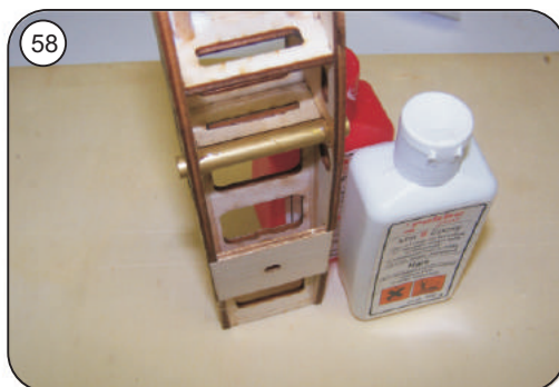
Steckungsrohr M 9 mit Epoxy einharzen
