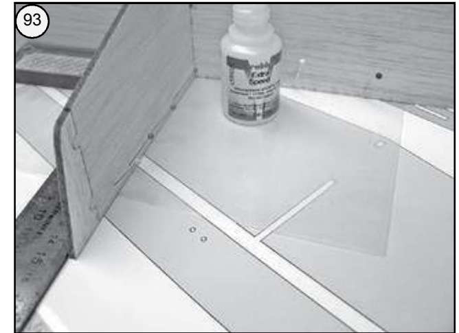
Bild 93 - Zusammengesteckte Leitwerke mit einem Winkel 90° zueinander ausrichten und mit Sekundenkleber verkleben.
