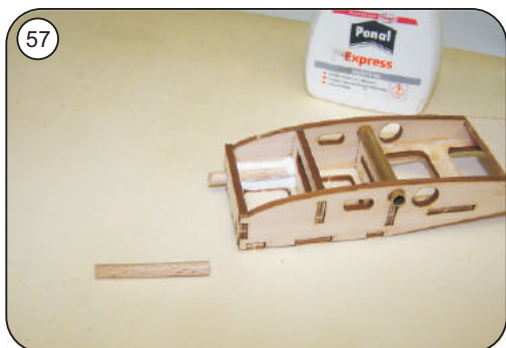
Steckungsdübel M 8 einkleben, auf gute Verklebung achten !
