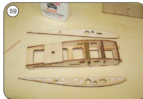
Abschlussrippen M10 mit Buchendübel am Mittelstück ausrichten und verkleben
