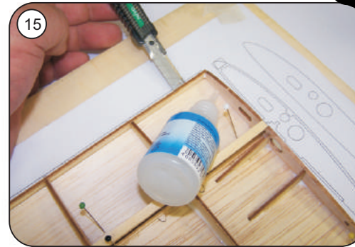
Untere Nasenbeplankung F 1 anheben und mit Sekundenkleber anheften
