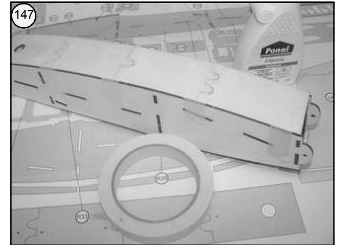
Bild 147 - Bodenbeplankung auf die Unterseite des Rumpfes kleben, mit Krepfstreifen bis zum Durchtrocknen verspannen.
