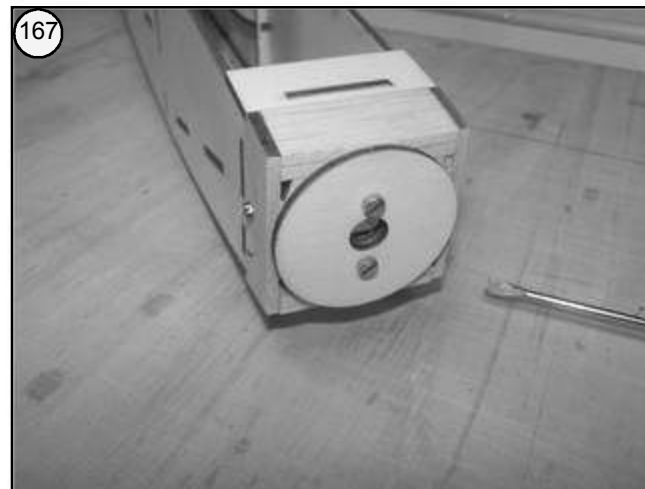
Bilder 167 und 168 - Hilfsspant MT 13 am Motorspant anschrauben und den Rumpfkopf mit Schleifklotz und feinem Schleifpapier verrunden. Hilfsspant MT 13 dient dabei als Schleifanschlag.
