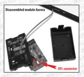
Das Modul muss nun mit dem Empfänger gebunden werden, siehe unten. Vorsicht beim Einschalten des Senders Aurora 9, das Modul ist nicht eingeschaltet, solange der Sender sich nicht im Sendemodus befindet. Ob das Modul eingeschaltet ist erkennt man an der blinkenden roten LED. Die blinkende rote LED am Modul zeigt an, dass das Modul mit dem Sender kommuniziert. Beim Sender im Duplex-Modus leuchtetauch noch die grüne LED.
