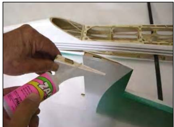
Flächenübergang mit Medium-Sekundenkleber benetzen.
