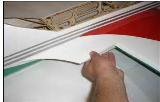
Anpassen und ausrichten des Abschlusses der Tragfläche.
