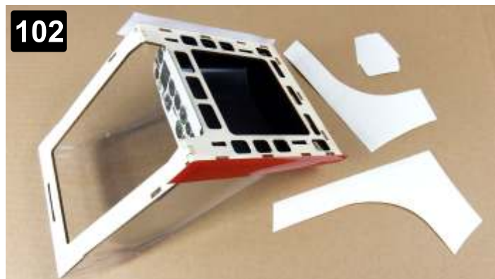
102 Takhle by měl vypadat výsledek. Přesahy samolepky přes spodní hrany by měly být stejné. Přesahy nepřehýbejte. This should look like a result. The overlap of the sticker over the lower edges should be the same. Do not bend overlaps.
