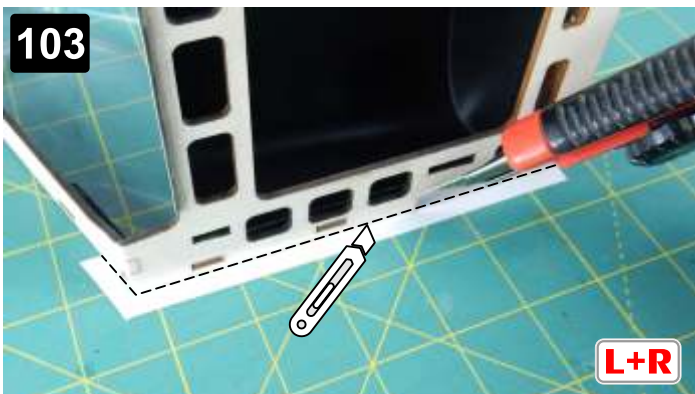
103 Přesahy samolepky ořízněte přesně podle hrany rámu kabiny. Cut the intersections of the sticker exactly according to the windshield frame edge.
