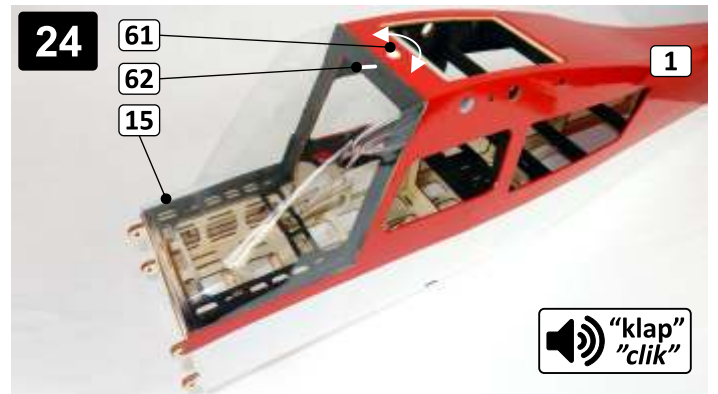
24 Na trup nasadte kabinu (15) a vyzkoušejte její zajištění / odjistižení pootočením pojistky (61). Pojistka zapadne do vybrání v kabině. Attach the wind shield (15) to the fuselage (1). Check lock / unlock the wind shield turning the screw (61).
