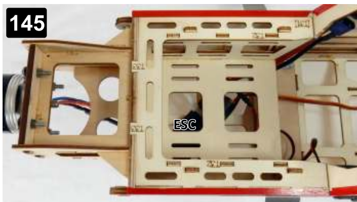
145 Regulátor do modelu nainstalujte a připevňte dle pokynů výrobce. Použijte např. stahovací pásky. Regulátor připojte k přijímači. Follow the manufacturer's instructions when installing ESC. You can use cable ties e.g. Connect ESC to the receiver.
