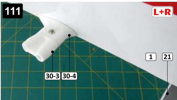
111 Sestavu dílů (30-3, 30-4) vložte do otvoru v trupu (1) a přišroubujte je šrouby (54). Insert parts (30-3, 30-4) into opening in fuselage (1) and screw it with screws (54).
