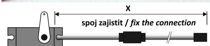
79 Spoje kabelů zajistěte proti nechtěnému rozpojení! Přelepením skelnou páskou, zalepením tavným lepidlem nebo přetažením smršťovací bužírky! Fix connection of servo cables well! Use glass self adhesive tape, or hot glue, or shrinkable tube.
