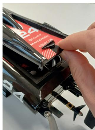
Das im Lieferumfang enthaltene Klettband auf der Unterseite des Akkus befestigen. Um den Akku im Modell zu platzieren muss die Haube auf der Oberseite geöffnet werden. Den Akku in der vorgesehenen Akkuhalterung wie abgebildet im Modell platzieren.
