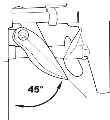
Das Modell verfügt über zwei Turn-Finnen am Heck. Die Finnen werden wie abgebildet auf 45° eingestellt. Diese verbessern den Geradeauslauf und beeinflussen das Kurvenverhalten des Modells.
