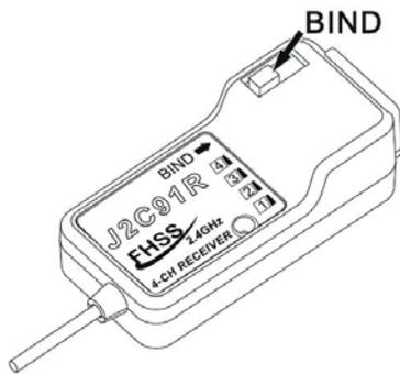
Der im Lieferumfang enthaltene Sender ist bereits mit dem im Modell eingebauten Empfänger verbunden. Falls der Sender nicht mehr mit dem Empfänger gebunden sein sollte (die rote LED im Empfänger ist dann an und die rote LED am Sender blinkt) geht man wie folgt vor:
