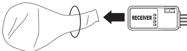
Der Empfänger des Modells kann mit dem im Lieferumfang enthaltenen Luftballon gegen Wasser geschützt werden. Den Empfänger wie abgebildet in den Luftballon stecken und mit dem Kabelbinder vorne am Austritt der Kabel schließen.
