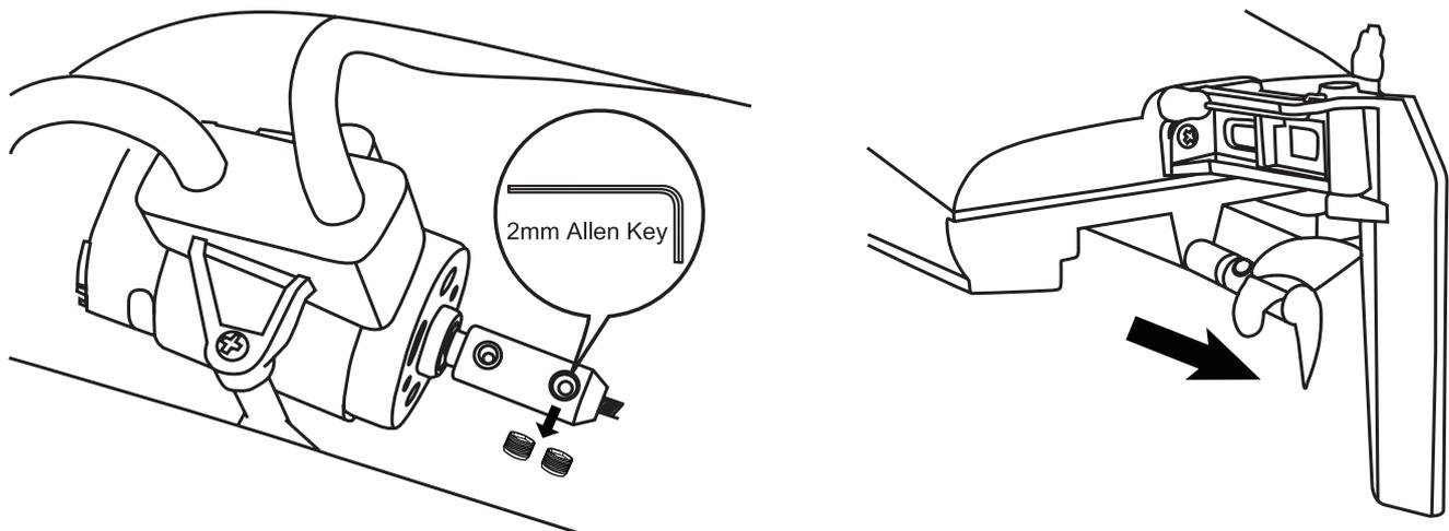
Das Schmieren der Antriebswelle erhöht die Lebensdauer der Antriebswelle und verhindert das Eindringen von Wasser durch die Welle in den Rumpf. Die Welle sollte nach jeder zweiten bis dritten Benutzung des Modells gefettet werden.
