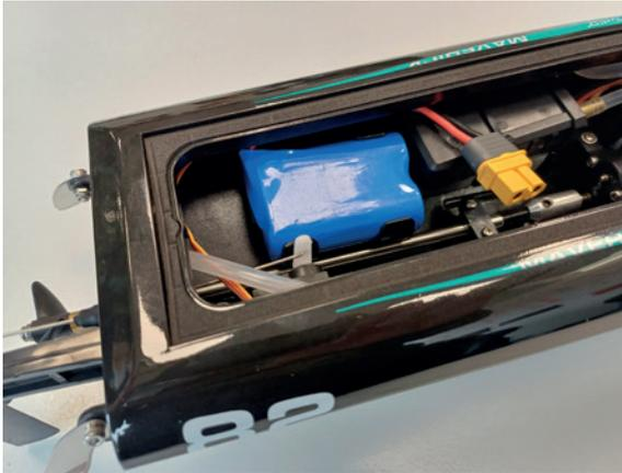
Um den Akku im Modell zu platzieren muss die Haube auf der Oberseite geöffnet werden. Den 7.4V Li-Ion Akku in der vorgesehenen Akkualterung wie abgebildet im Modell platzieren.
