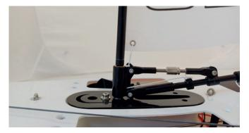
Den Hauptmast auf den bereits montierten Mastverbinder im Rumpf aufschieben.
