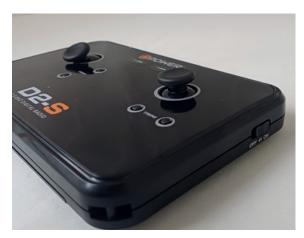
Der Sender verbindet sich nach dem einschalten automatisch sobald das Modell eingeschaltet wird. Es gibt keinen "Bind" Knopf.
