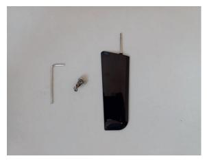
Für die Montage werden das Ruder, Ruderhebel und Sechskantschlüssel benötigt.
