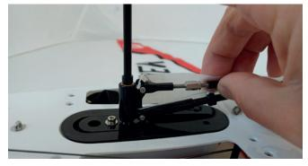
Den Mastverbinder mit der längeren Seite durch den Hauptausleger stecken und dann in das Rumpflager einschieben.
