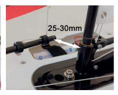
3. Die Leine vom Vorsegel durch die zweite Öse von vorne fädeln. Dann die Schlaufe der Leine in den hinteren Hacken hängen. Mit mit "SR3" und "SR4" das Vorsegel so justieren, dass der Abstand zwischen dem Ende des Auslegers und dem Hauptmast 25-30 mm beträgt.
