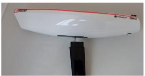
Den fertig montierten Kiel von unten in die entsprechende Aufnahme im Rumpf stecken.
