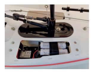
Die vier AA Batterien in die entsprechende Halterung rechts im Rumpf einlegen. Die Halterung kann zum einlegen der Batterien vorsichtig aus dem Rumpf genommen werden. Beim einlegen der Batterien auf die richtige Polung achten! Die eingesetzten Batterien gegen verrutschen mit dem Klettverschluss sichern.
