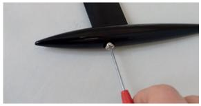
Das Ballastgewicht mit der Schraubenmutter von unten am Kiel befestigen.
