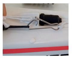
2. Die Leine vom Hauptausleger durch die hintere Öse in der Mitte fädeln, danach durch die hintere Öse links fädeln und die Schlaufe der Leine in den hinteren Hacken hängen. Der Ausleger des Hauptsegels soll nun exakt parallel zur Rumpfmittelachse stehen, ggf. mit "SR2" und "SR3" korrigieren.
