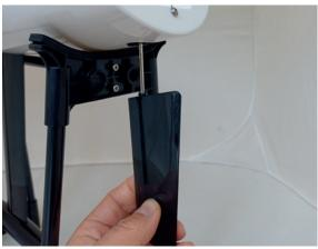
Unter Berücksichtigung der richtigen Einbaurichtung, dass Ruder von unten in die entsprechende Aufnahme im Rumpf schieben.
