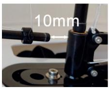
Die Leine, die bereits an "SR2" befestigt und durch "SR1" geführt ist durch die vordere Öse an der Rumpfspitze fädeln. Dann die Leine mit einem Haken an der dahinter liegenden, zweiten Öse befestigen. Durch Verschieben von "SR2" kann die Länge der Leine eingestellt werden. Der Abstand zwischen dem Ausleger und dem Hauptmast soll ca. 10 mm betragen.
