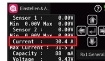
Unabhängig davon, aus welchem Grund auch immer die Stromregelung aktiviert werden soll, egal ob z. B. wegen eines maximal nur mit weniger als 40A belastbaren Motors oder Motorstellers oder aus Rücksicht auf das nur maximal 40A vertragende General Air-Modul, das Vorgehen ist in beiden Fällen das Gleiche: Es muss bekannt sein, an welcher Servoposition der limitierende Wert überschritten wird.
