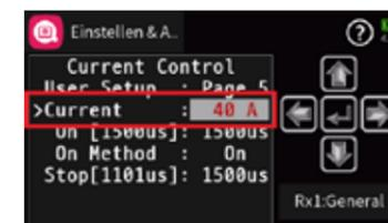
2. Soll das GAM weiterhin genutzt werden, ist entweder mit den Methoden des jeweiligen Senders der voreingestellte Wert von „1500µs“ manuell auf den gewünschten Wert zu bringen und abzuspeichern. Oder alternativ der „Gaskanal“ des Empfängers mit einem beidseitig mit JR-Steckern versehenen Servokabel mit der Buchse „CS“ (11) zu verbinden:
