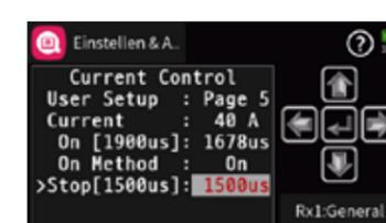
4. Nun kann mit dem Gasgeber des Senders die zuvor ermittelte Gasposition angesteuert und hernach diese, im Display zwischen den linken eckigen Klammern in [XXXXµs] angezeigte, Gasposition durch Antippen bzw. Drücken der ENTER-Taste oder Äquivalent in das rechte Wertefeld übernommen werden. Durch Antippen oder Drücken der „AUF“- oder „AB“-Taste bzw. deren Äquivalent, kann ggf. dieser Wert verändert werden.
