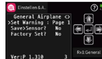
Die zweite Displayseite –die mittlere der weiter oben abgebildeten drei– fasst unter dem Oberbegriff „Set Warning“ 22 weitere Unterseiten zusammen, auf welchen die standardmäßigen Warnparameter individualisiert und abschließend auf der „Page 1“ gesichert oder ggf. wieder verworfen werden oder gar das Modul auf die Werkseinstellungen zurück gesetzt wird.
