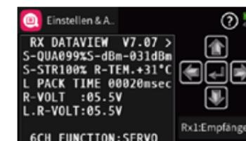
Entsprechend der jeweiligen Senderanleitung ist nun das Menü „Einstellen & Anzeigen“ bzw. „Setting & DataView“ zu öffnen. Unmittelbar nach dem Öffnen dieses Menüs wird die erste Empfängerseite angezeigt, siehe Abbildung links.
