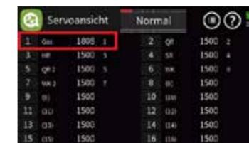
Trifft Letzteres zu, ist die Gasposition festzustellen, bei welcher diese Ampere-Grenze erreicht ist. Am einfachsten gelingt das über die µs-Version oder alternativ über die %-Version der Servoanzeige. Nach Abbau der Testkonstellation ist dann wie folgt vorzugehen:
