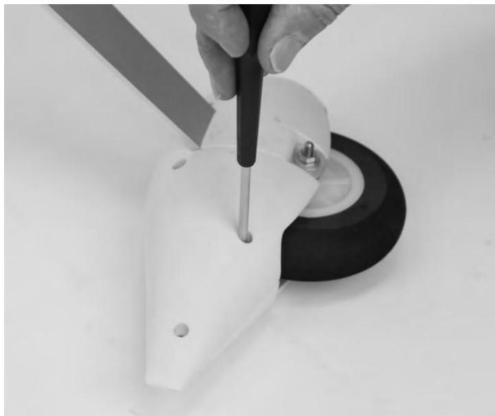
7. Blaue Gewindesicherung auf die vier M3x20-Maschinenschrauben auftragen. Verwenden Sie einen Kreuzschlitzschraubendreher Nr. 1 und die vier M3x20-Schrauben, um das Fahrwerk am Rumpf zu befestigen.
