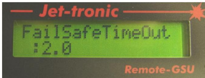
Dies ist die Zeit, bevor die Turbine abgeschaltet wird. (Standardwert = 2 Sec) Sie beginnt mit Ablauf der Zeit „**Fail Safe Delay**“ und kann bis zu 20 Sec ausgedehnt werden. Während dieser Zeit wird die Turbinendrehzahl auf den Parameter „**Fail Safe RPM**“ eingeregelt.
