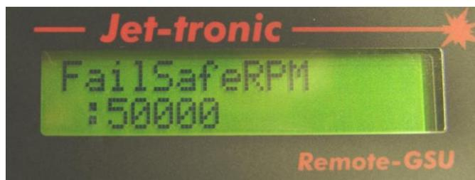
Dies ist die Drehzahleinstellung, in der die Turbine während der „**Fail Safe Timeout**“ Zeit laufen soll. (Standardwert = Leerlaufdrehzahl)
