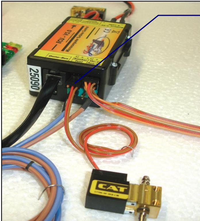
Kraftstoffventil auf unteren Steckerausgang (unterhalb Smoker) einstecken.
