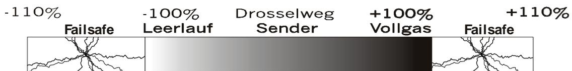
Damit bei PCM die ECU feststellen kann, ob ein Fail Safe vorliegt, ist der Sender so zu programmieren, dass im Fail Safe Fall empfängerseitig Impulse ankommen, die eindeutig außerhalb des zuvor eingelernten Bereichs liegen.
