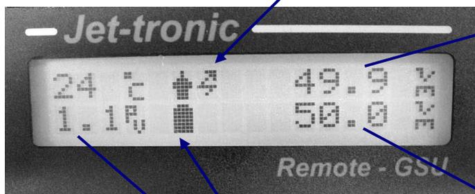
Turbinen-Ist-Drehzahl in 1000 Umdrehungen/min
