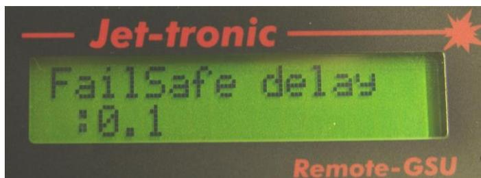
Dies ist die Verzögerungszeit bevor die vorprogrammierte „**Fail SafeRPM**“ eingeleitet wird. Sie ist Standardmäßig auf 0,1Sec eingestellt, kann jedoch bis zu 20 Sec ausgedehnt werden.
