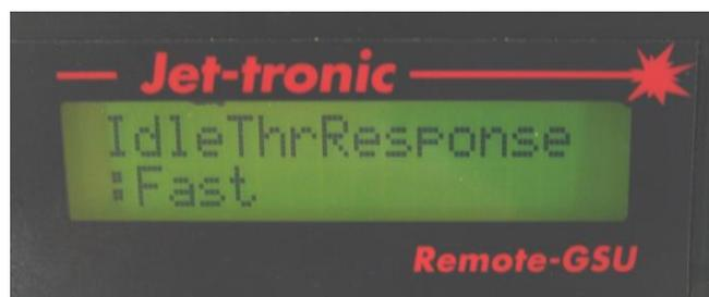
Die Einstellung „slow“ entspricht etwa der alten P160 und ist bereits sehr schnell. Die SE/SX-Einstellung und damit die äußerst direkte Gasannahme durch kontrollierten Flammenschlag werden bei „fast“ erreicht.
