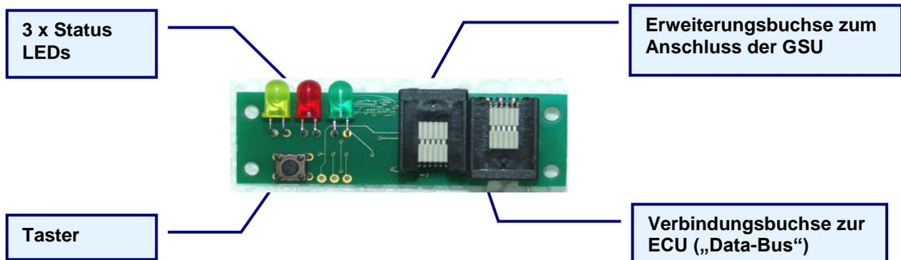
Erklärung der Leuchtdioden auf der LED Platine
