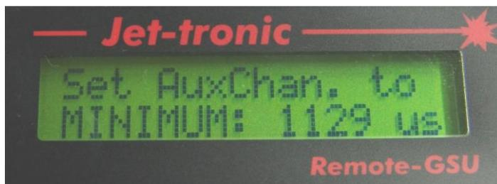
→ „Stelle Dreistufenschalter auf Minimum = untere Position = AUS Position“
