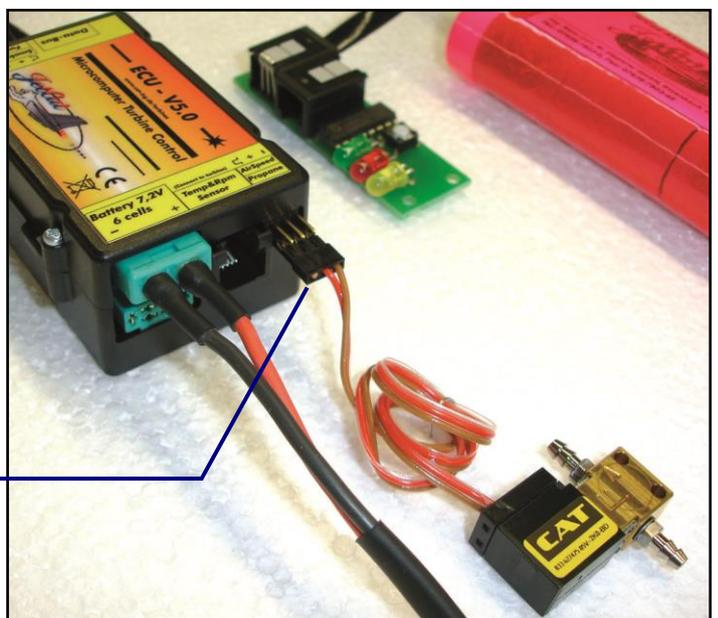
Kerosinstartventil auf den unteren Steckerausgang (Propane) (unterhalb AirSpeed Eingang) einstecken. Polung beachten!
