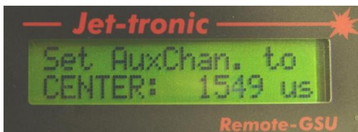
→ „Stelle Dreistufenschalter auf Mittelstellung = mittlere Position = Start/Standby Position“
