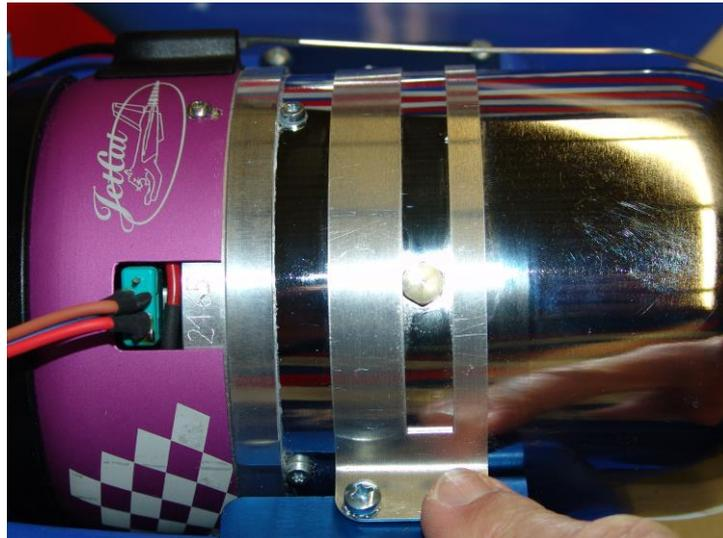
Wir empfehlen beim Betrieb unserer Turbinen einen Ansaugschutz zu verwenden, um grobe Schmutzpartikel zuverlässig von der Turbine fernzuhalten.
