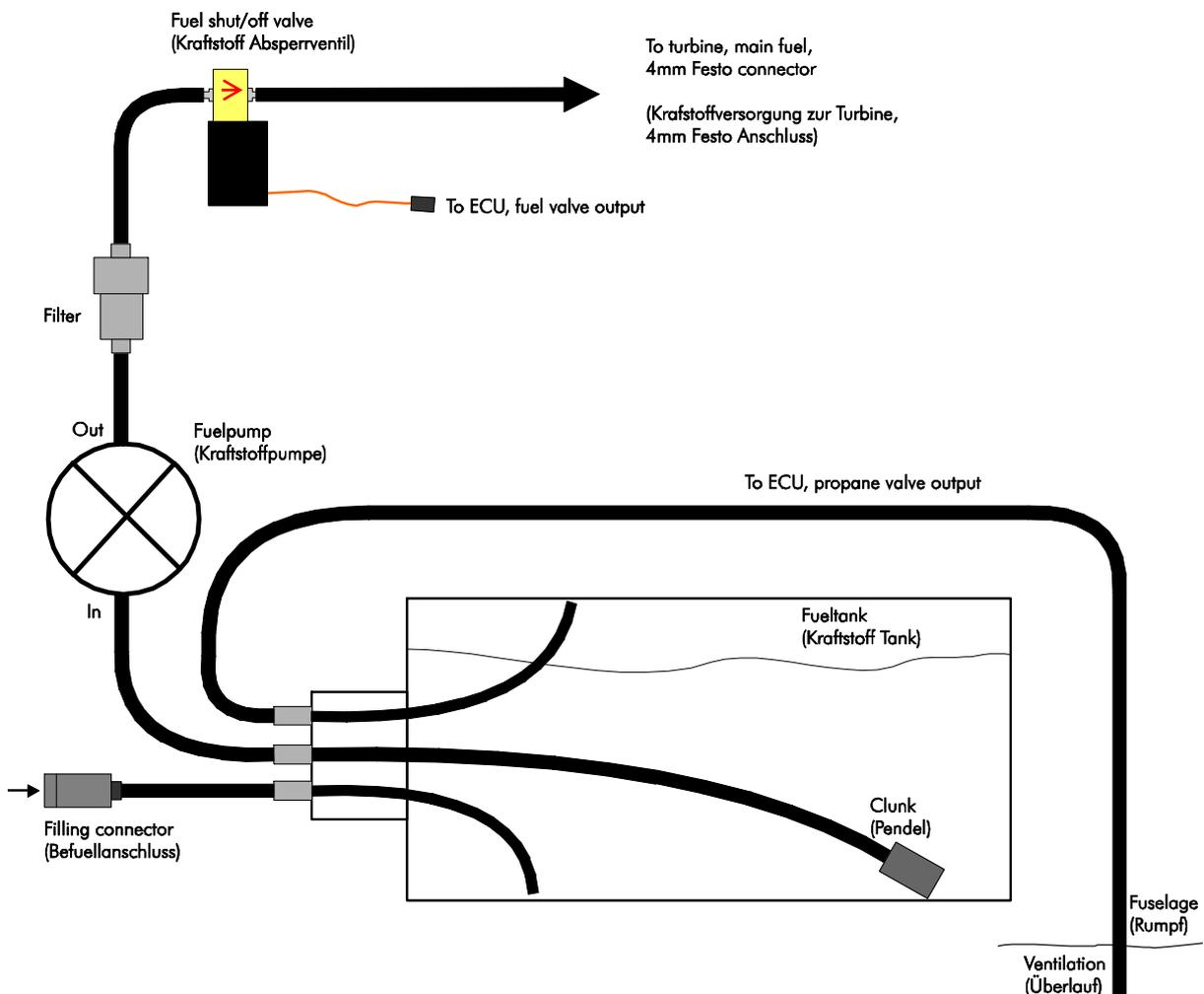
Für einen störungsfreien Betrieb wird generell empfohlen, die Schlauchlänge auf der Saugseite der Pumpe so gering als möglich zu halten (Gefahr von starker Unterdruckbildung → Kavitationsblasenbildung→Absteller). Auf der Druckseite der Pumpe ist die Schlauchlänge relativ unkritisch.
