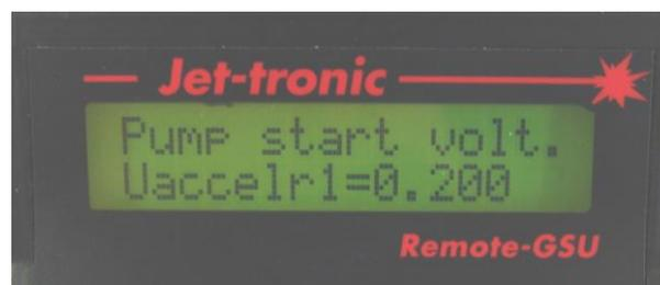
Die Pumpe kann nun durch Drücken und Halten der „RUN“ Taste gestartet/getestet werden.
