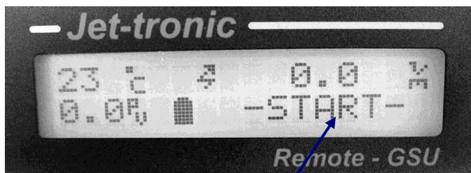
Während des Startvorganges wird unten rechts der Turbinenzustand anstatt des Abschaltgrundes angezeigt.
