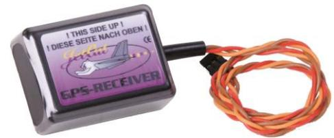
Zum Verwenden des optionalen GPS-Empfängers muss im LIMITS-Menu die entsprechende Option aktiviert worden sein (→ Im Limits Menü den Parameter: „GPS-Receiver“ auf „ENABLED, COM2“ stellen ). Ist dies erfolgt, wird das GPS-Menu freigeschaltet und kann dann mit der GSU angezeigt werden. Der GPS-Empfänger wird direkt in den mit „GPS“ bezeichneten Anschluss an der ECU eingesteckt.
