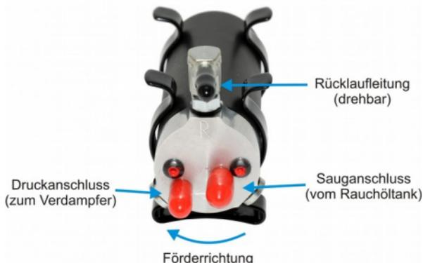
Die Förderrichtung ist mit einem Pfeil gekennzeichnet. Der mit „R“ gekennzeichnete Anschluss (Schwenkverschraubung) ist zum Tank zurückzuführen. Die Rücklaufmenge beträgt ca. 35ml/min. Um keinen separaten Anschluss an den Tank anbringen zu müssen, kann in den Betankungsschlauch zum Tank das beiliegende T- Stück eingeschleift werden. Dort wird dann der Rücklauf angeschlossen.
