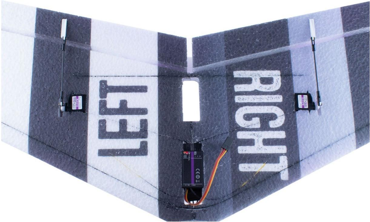
6. Akkuanschluss und Bindingstecker / *battery connection and binding plug*
