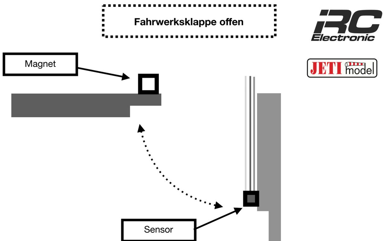
**Der Abstand Magnet zum Sensor zum auslösen liegt zwischen 2-15mm! Je nach Ausrichtung!**
