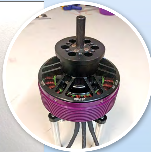
Elekromotor Hacker Q100 6m je upevněn na čtyřech vysoustružených sloupcích, regulátor JETI SPIN 300 je přišroubován zespodu motorového domku.
