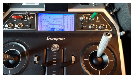
Abbildung 12: SW1 in Aus-Stellung: Glühkerze in der Abkühlphase (170°C).
