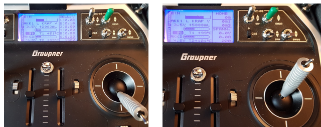
Abbildung 11: SW1: Ein, Links: Motor im Leerlauf, Glühkerze wird auf 610°C aufgeheizt. 2/3-Gasstellung im Leerlauf, Glühkerze wird auf 1010°C aufgeheizt.
