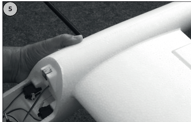
Abbildungen 4 und 5: Schieben Sie die Tragfläche in die Aussparung am Rumpf. Das Anschlusskabel vorsichtig durch die Aussparung in der Rumpfmittle nach vorne in den Rumpf ziehen.
