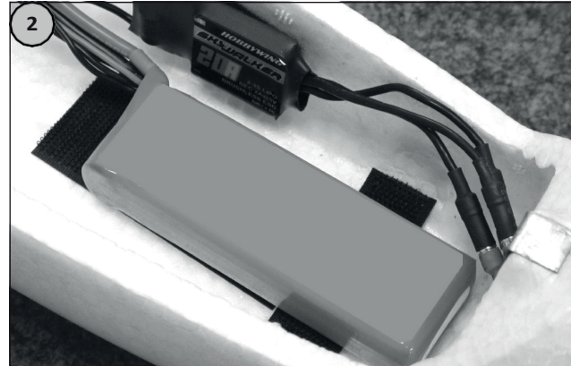
Abbildung 2: Zum sichern des Flugakkus gegen verrutschen das Klettband (Haken Seite) auf den Rumpfboden kleben. Den Flugakku so einlegen ein das sich das Modell im Schwerpunkt (Seite 14) befindet. Darauf achten, dass das Klettband am Akku (Flausch) richtig in das Gegenstück im Rumpf einhakt. Bei montiertem Kamerahalter und Kamera verändert sich die Gewichtsverteilung. Schwerpunkt beachten (Seite 14) Schließen Sie den Akku NICHT an!
