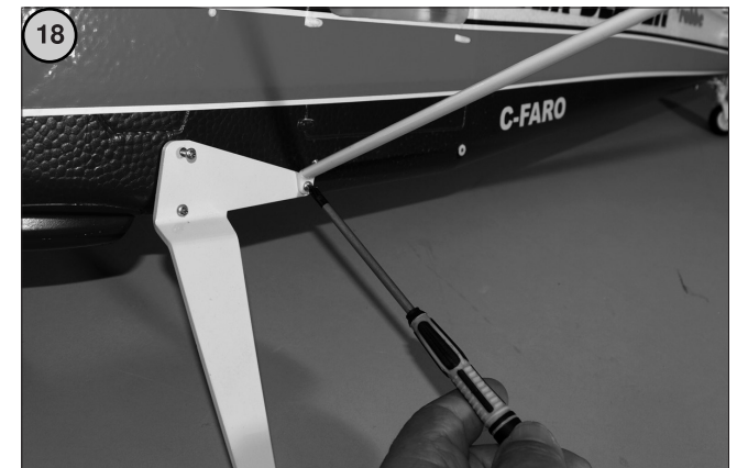
Bild 18 - Hauptfahrwerke und Tragflächenstreben am Rumpf verschrauben.
