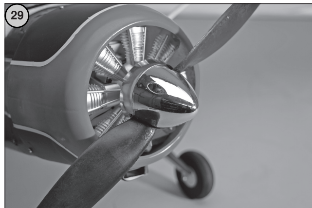
Bild 29 - Spinnerkappe aufsetzen und befestigen.
