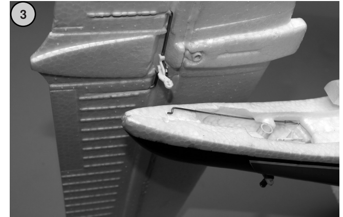
Bild 3 - Das Höhenrudergestänge nach hinten ziehen.
