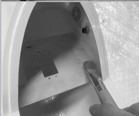
Nun kann auch das Servobrett an der zuvor ermittelten Stelle im Rumpf eingeharzt werden. Dazu sollte das Höhenrudergestänge bei neutralem Ruder und 90° Servohebel eingehängt werden. Die Rumpfsseitenwände müssen vorher entsprechend angeschliffen werden. Wir empfehlen die Verklebung mit einer Lage 160g Matte zu verstärken.
