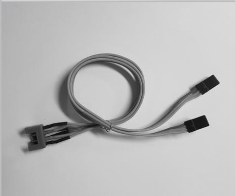
Löten Sie die ca. 50cm langen Servokabel an die Kontakte der MPX Stecker.
