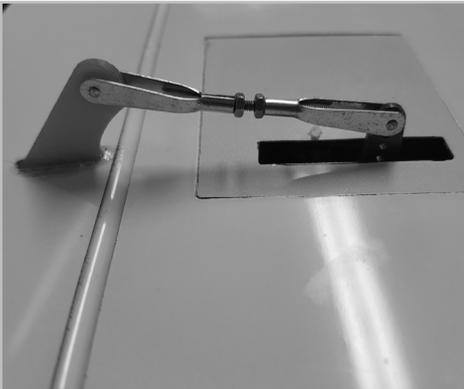
Die Länge der Querrudergestänge ergibt sich aus dem Abstand der Bohrungen bei 90° ausgerichtetem Servoarm und dem neutralen Ruderblatt.
