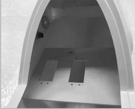
Beginnen Sie mit dem Anpassen des Servobrettes im Rumpf. Es sollte möglichst weit hinten vorm Steckungsrohr eingesetzt werden. Noch nicht jetzt verkleben!
