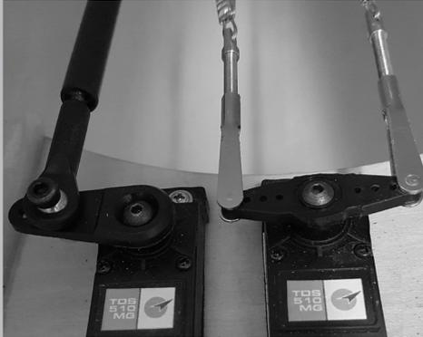
Schrauben Sie das Höhen- und Seitenruderservo in die vorgesehenen Aussparungen im Servobrett. Der Hebel des Höhenruderservos sollte bis Bohrung ca. 18mm lang sein, der Seitenruderhebel benötigt ca. 45mm Länge (Bohrung/Bohrung). Beide Servohebel sollten bei Neutralstellung 90° ausgerichtet sein.
