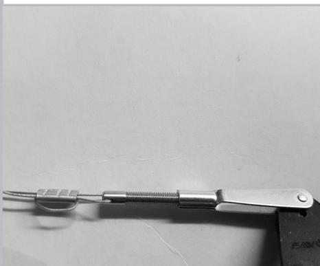
Fädeln Sie zunächst eine Quetschhülse auf das Seil und führen es durch die Bohrung eines Augbolzens hindurch und wieder durch die Quetschhülse. Achten Sie auf eine kurze Länge der Ösen. Beide Seiten können nun am Ruderhorn des Seitenruders mit einer Zange verpresst werden.
