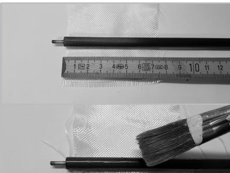
Optional: Um ein Aufplatzen des Rohres bei hohen Belastungen zu vermeiden, sollte das Rohr beidseitig mit Glasmatte verstärkt werden. Hierzu werden nach Anschleifen beide Enden mit getränkter 80g Glasmatte zweifach umwickelt.
