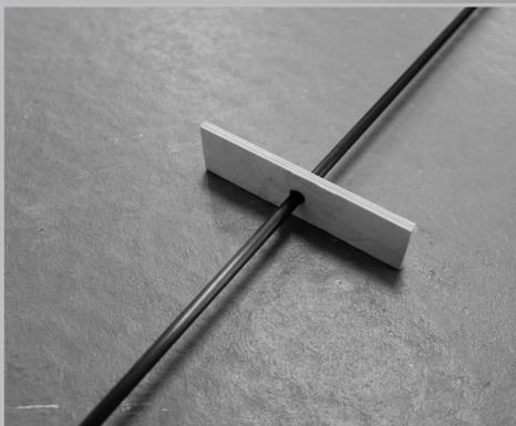
Die Sperrholz Führung für das Gestänge wird mit Epoxy auf ca. der halben Länge des Gestänges zwischen die Rumpfsseitenwände geharzt.
