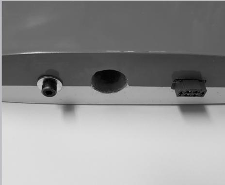
Für die elektrische Verbindung Rumpf/Fläche empfehlen wir die 6-poligen Multiplex Stecker, die wahlweise lose oder fest eingebaut werden können. Der feste Einbau erfordert zu Beginn etwas mehr Aufwand, erleichtert aber den Zusammenbau der SWIFT später auf dem Flugfeld enorm.
