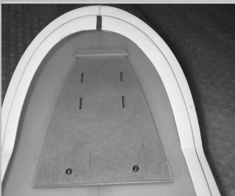
Der Empfänger und die Akkus sollten möglichst weit vorn im Rumpf platziert und gut befestigt werden. Kleben Sie hierzu die entsprechenden Sperrholzstege vorn quer in den Rumpf ein und schrauben Sie das Akkubrett daran fest. Befestigen Sie die Akkus mit Klett und Klettschlaufen.
